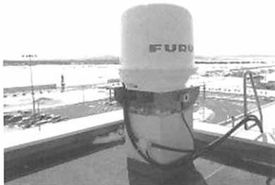
小型Xバンド二重偏波ドップラ気象レーダー「型式：WR-2100」の設置例
